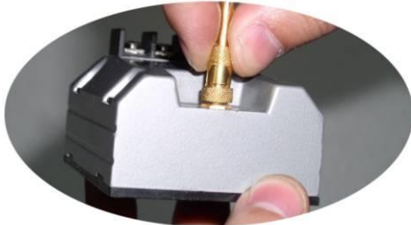
图 10—5 传感器系统的连接（K9000 系列前置器）
